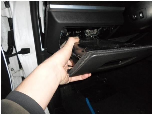
Снять перчаточный ящик.
