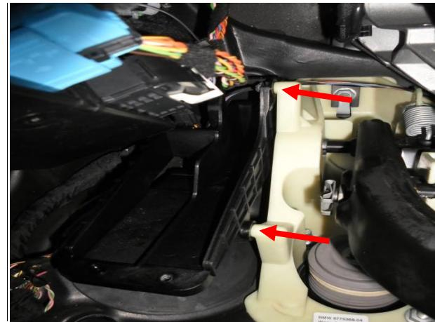
Снять ЭБУ. Отвернуть 2 самореза крепления ЭБУ и отвести в сторону.
