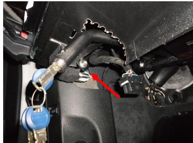
Притянуть замок к дополнительному кронштейну. В момент затяжки приподнять максимально вверх.
