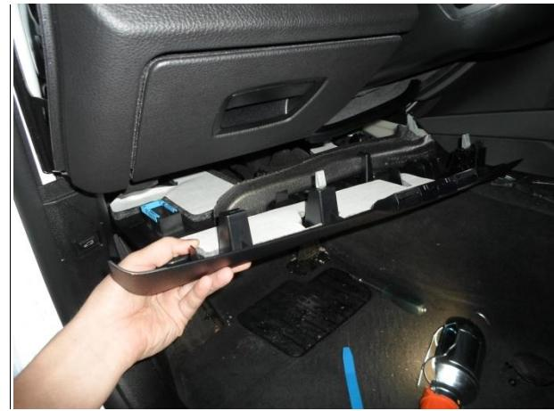
Снять панель, отсоединить фишкы.
